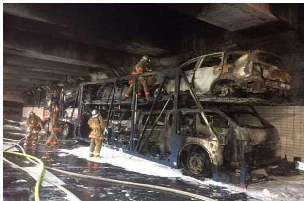
日時 2019年10月22日(火)5:45 場所 都心環状線(内)三宅坂JCT 原因 トラクター部左後輪バーストからの出火 積荷 乗用車6台 (通行止め時間 3時間49分)
