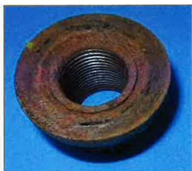
著しいさびや汚れによる ホイール・ナットとワッシャ の固着
