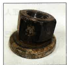
劣化したホイール・ナット
