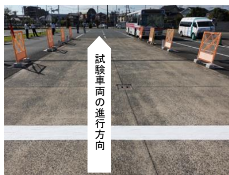
写真3-3 制動ポイント（白線）と試験路面
