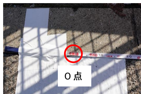
写真3-4 巻き尺設置状況（制動距離測定用）
